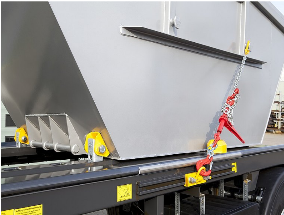
Zabezpieczenie ładunku metodą łączoną z Zentrier-Fix i łańcuchami mocującymi
