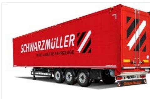
*Der Schubboden-Sattelanhänger ist auch mit Telematik ausgerüstet.
