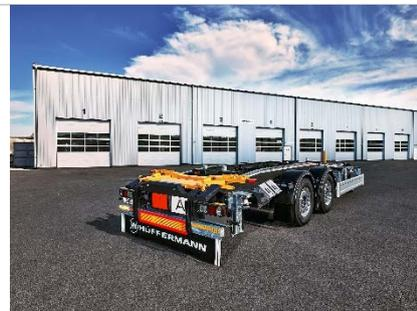
*2-Achs-Zentralachs-Schlitten-Carrier für den Transport von Abrollcontainern und Wechselbrücken.
