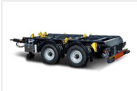
*Mini-Carrier zum Transport von Absetzbehältern.
