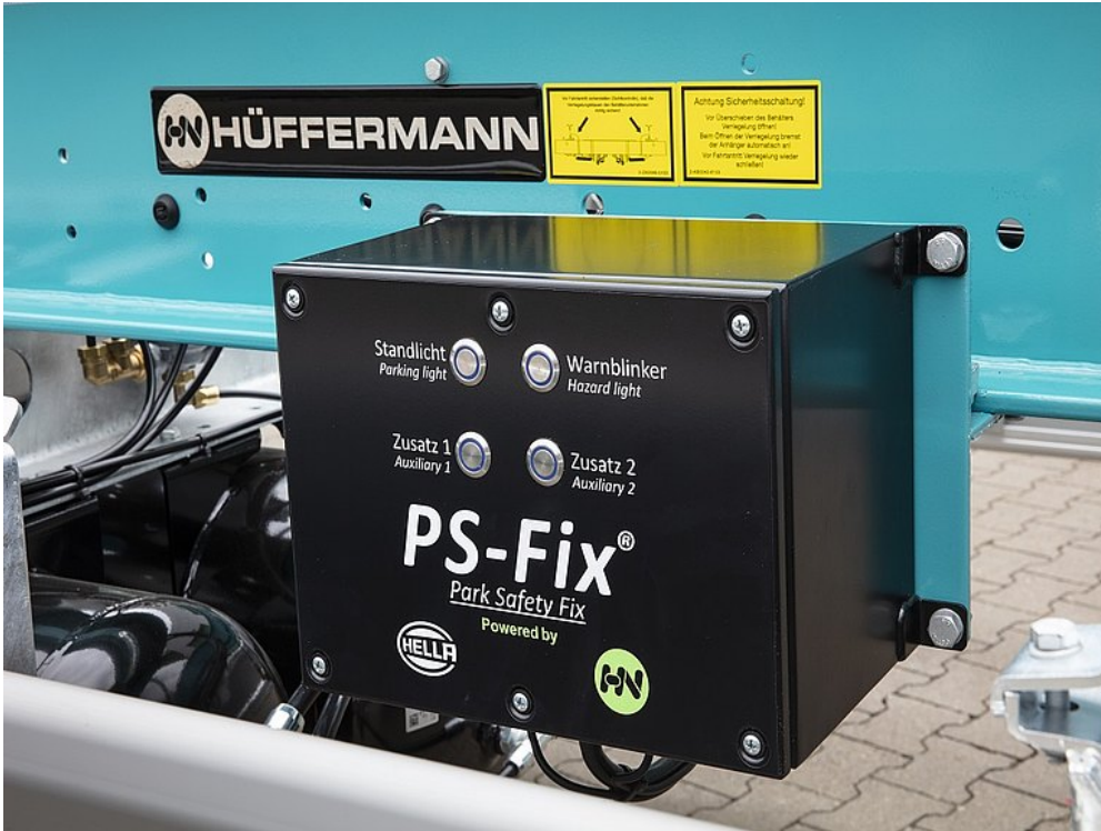
OPTIONAL: Das autarke Beleuchtungssystem für mehr Sicherheit
