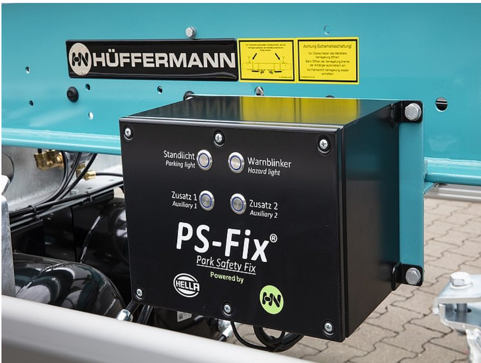
OPTIONAL: Das autarke Beleuchtungssystem für mehr Sicherheit.
